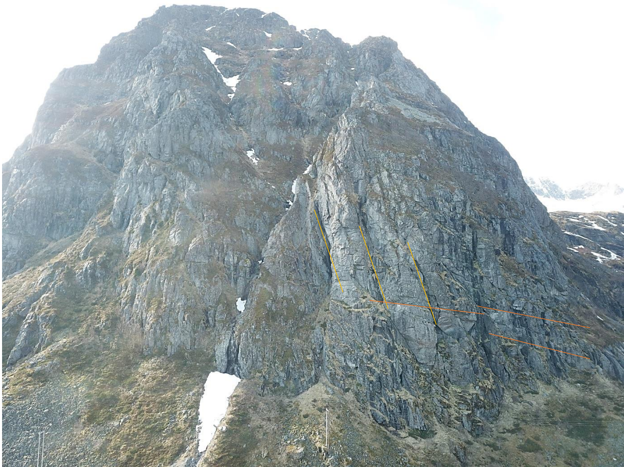
Figur 4: Bilde som viser oppsprekking av berg i påvirkningsområdet. Det er hovedsakelig to sprekkesett. Ett tilnærmet parallelt med terrengoverflaten (gule streker), og ett ca. 90° på dette (oransje streker).
