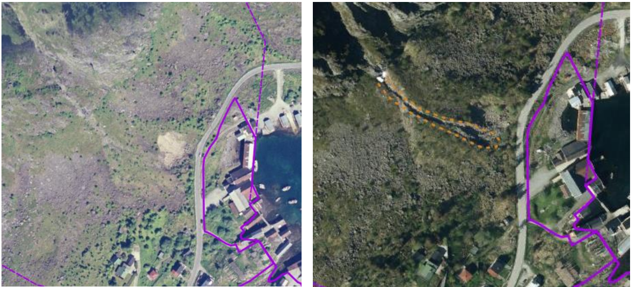
Figur 6: Flybilde fra 2004 til venstre, og fra 2009 til høyre. Flomskred er antydnet med oransje stiplet linje.
